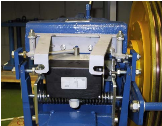
Abb. 6 : Kipphebelsystem zum getrennten mechanischen Öffnen der Bremshebel
